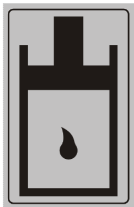
14)Маркировка системы гидравлики
