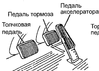
Погрузчик с рычагом управления направлением движения (С единой тормозной/толковой педалью)
