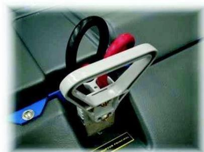
*Штабелер готов к работе. Поворачивать ключ можно только при полностью поднятой или опущенной ручке управления.*
