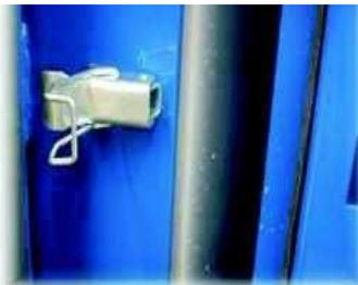
7- Удалить фиксатор удерживающий аккумулятор.
