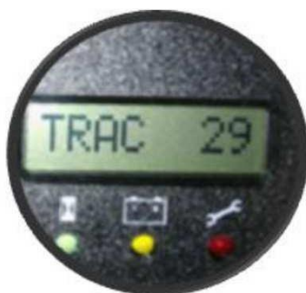
Рис. 8-11. Отображение неисправности на дисплее Curtis 840
