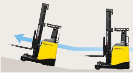
Превосходные возможности по преодолению подъемов и \*На фото может быть показано дополнительное оборудование. функция, защищающая от скатывания назад
