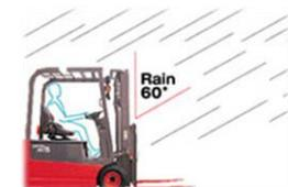
**Класс влагозащитности IPX4.** При влагозащитности со степенью электробезопасности IPX4 погрузчик может работать даже при дожде.
