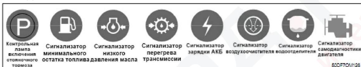
Данные сигнализаторы загораются при наличии неисправности (за исключением контрольной лампы стояночного тормоза)
