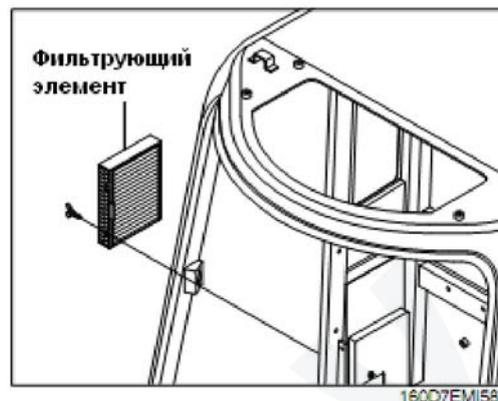
2. Продуйте фильтрующий элемент сжатым воздухом под давлением не выше  $2\text{ кгс/см}^2$ .
