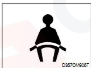
Лампа загорается и звучит зуммер в течение первых 3 секунд после запуска двигателя.
