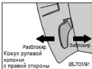
Рулевая колонка регулируется по наклону (вперед/назад).
