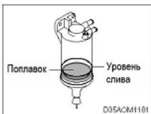
(3) Слейте воду из водоотделителя, если поплавков поднялся до красной линии.
