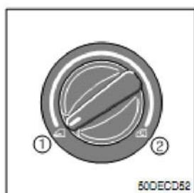
1. Если переключатель установлен в положение (1), воздух забирается снаружи.
