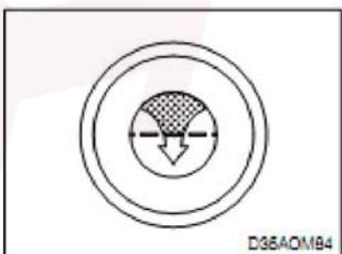
Лампа загорается в случае чрезмерного загрязнения фильтрующего элемента воздушного фильтра.
