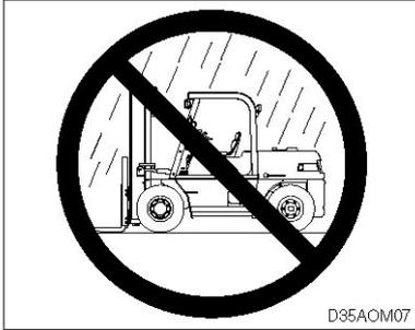
Эксплуатация погрузчика, не оборудованного закрытой кабиной, под дождем запрещена.
