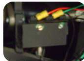
1 резистор 5 Вт на электронном тормозном блоке
